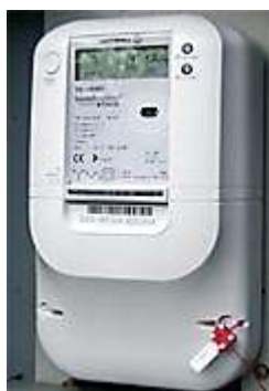
Scatola con il GPRS-Trasmittitore ed il sistema del PLC
